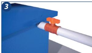
3. Verificar toda a tubulação evitando qualquer eventual vazamento. Para manutenção periódica recomenda-se a instalação de um registro na entrada da Caixa Separadora de Gordura PRFV.
