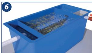
6. A periodicidade da limpeza da Caixa Separadora de Gordura PRFV, dependerá da quantidade de gordura gerada/acumulada na superfície do equipamento. A limpeza deve ser feita manualmente. Não se recomenda utilizar ferramentas e acessórios com arestas cortantes. Evite também o uso de produtos químicos, utilizando apenas água, sabão neutro, pano e/ou esponja.
